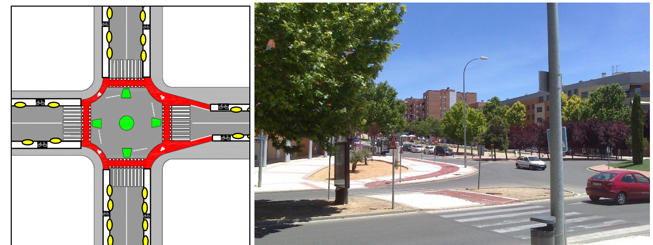
Croquis de diseño de un carril bici protegido a su paso por una rotonda (izquierda). Ejemplo en Guadalajara (derecha)
